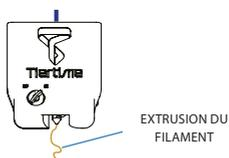
6 Pour terminer, emboîtez le guide fil dans le trou où est inséré le filament et clipsez le tube sur le montant de la tête d'impression.
